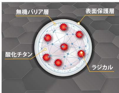
ラジカルの発生源である酸化チタンの表層を保護し、ラジカルの発生を抑制します。
