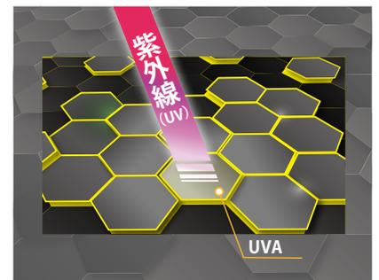
ラジカル発生のエネルギー源となる紫外線を変換し、ラジカルの発生を抑制します。
